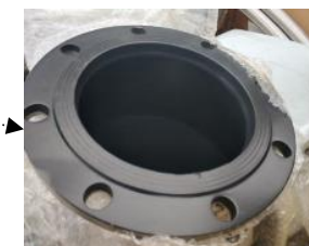
●犁刀混合机筒体，304不锈钢内衬陶瓷片
